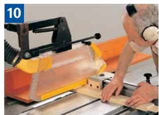
10 Schutzeinrichtung und Handhaltung beim Absetzen von Zapfen.
