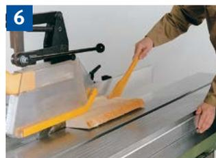
6 Sägen schmaler Werkstücke mit Schiebestock.
